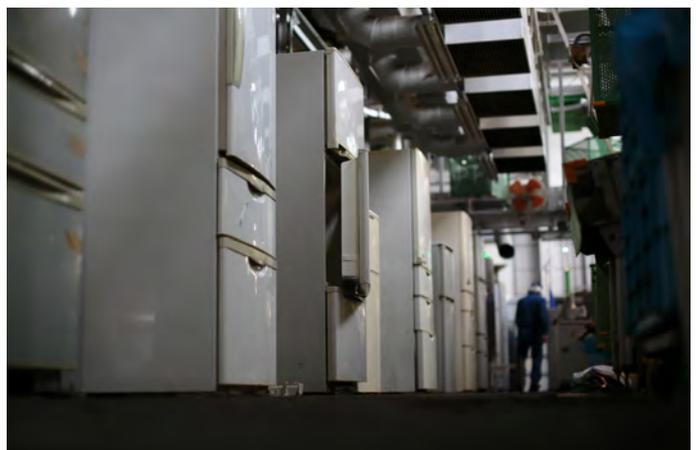
冷蔵庫は冷媒がフロンだったりノンフロンだったり、断熱のためにガスを使ったりするので、それぞれ別の対応が必要。そのため、冷蔵庫の機種ごとにどの種類かのデータベースができており、まずそれと照合してタイプを割り出し、種類ごとに違うシールを貼ってラインに乗せていきます。
